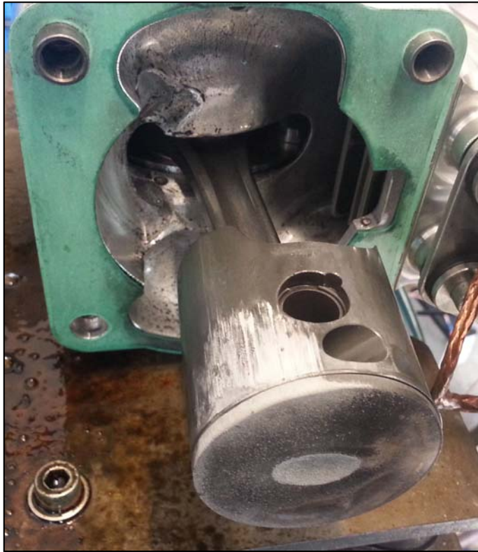
Joonis 2: Testpingis koormustestide käigus ohutuskriitilise temperatuuri ületanud mootori kolb
