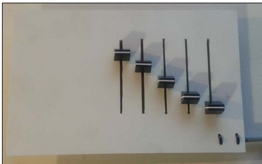
Joonis 8: Potentsiomeetritega testtrakis
